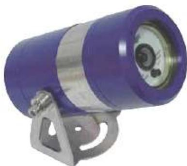
**Dräger Flame 5000** – взрывозащищенный детектор пламени, работающий на принципе обработки цветного видеоизображения. Каждый детектор работает как автономное устройство и включает встроенную систему CCTV (замкнутую телевизионную систему), систему обработки цифровых сигналов и программное обеспечение, позволяющие получить «живое изображение» и интерпретировать характеристики пламени по его форме и динамике.
